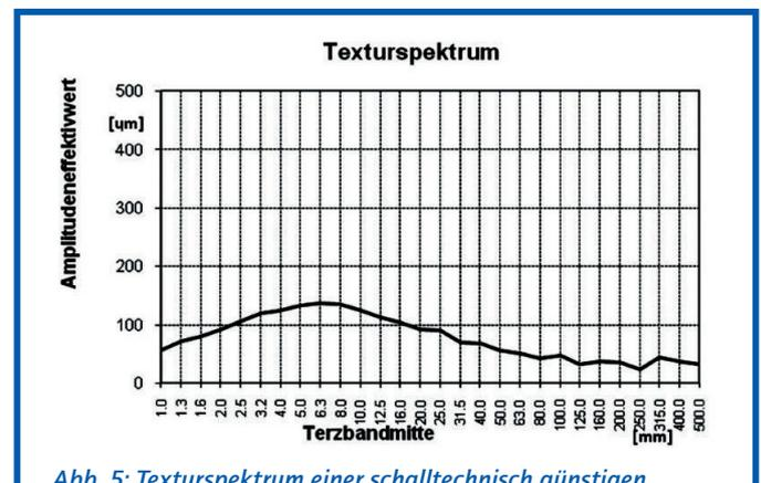
Abb. 5: Texturspektrum einer schalltechnisch günstigen Fahrbahn-deckschicht aus lärmtechnisch optimierten Dünnschichtbelages DSH-V 0/5 LA
